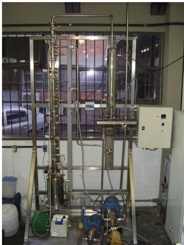
Figura 4.11. Fotografia da coluna de destilação reativa.
