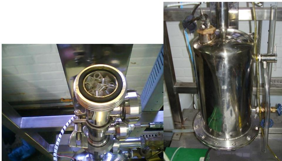
Figuras 4.12 e 4.13. Fotografias dos componentes da coluna de destilação reativa.
