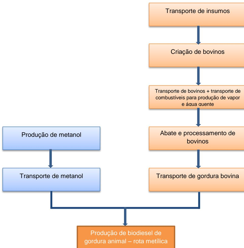
Figura 5.2. Representação do sistema de produto do biodiesel de gordura animal pela rota metílica. Fonte: CENBIO/IEE/USP, 2013.
