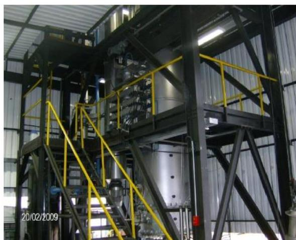
Figura 50 - Gaseificador na planta protótipo da Carbogas.
