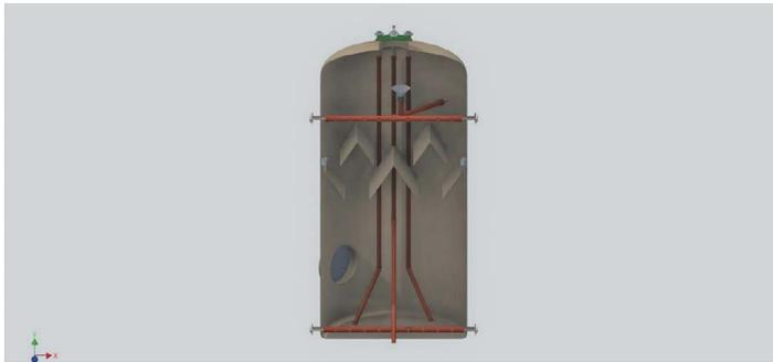
**Figura 3.6** – Corte – apresenta vista interna do biodigestor UASB.
