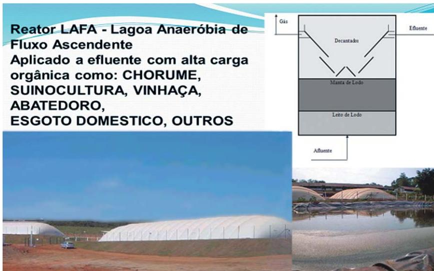
**Figura 6.4** – Lagoa tipo LAFA com sistema de distribuição de líquido.
