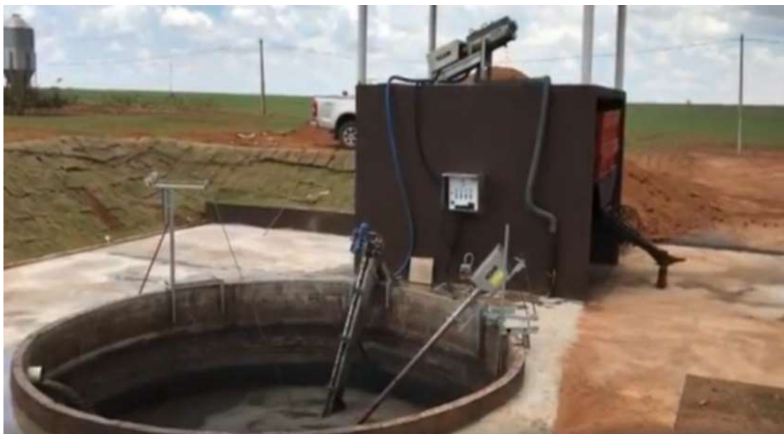
Figura 14 – Processo de separação da fração sólida e líquida nas unidades de produção
