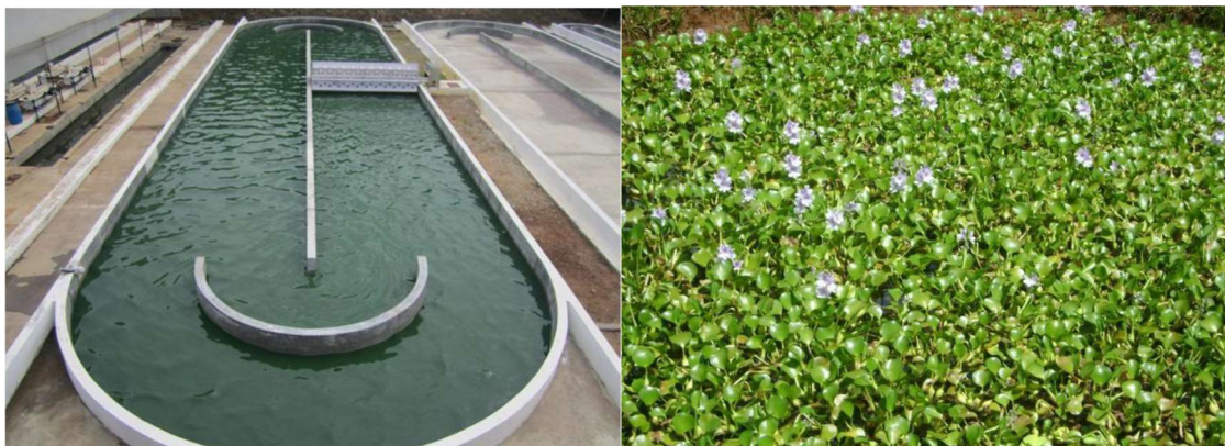
Figura 32 – Extração de nutrientes por microalgas e aguapé
